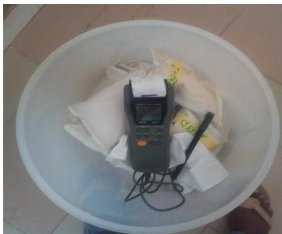
**Photo 12 : Image montrant le dispositif de mesure de la température et d'humidité relative du milieu de stockage des échantillons de farines**
